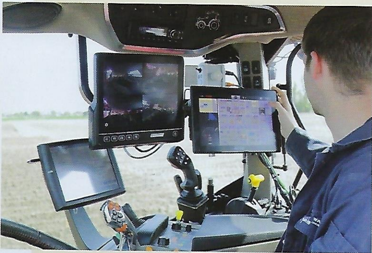
Het nieuws op de Grimme snarenbedpootmachines betreft het bedieningsscherm, de CCI 1200 (r) en de digitale cameraset met groot kijkscherm (m).
